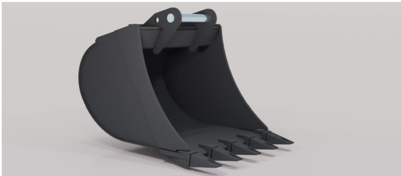
Hierbei handelt es sich um die Standard-Ausführung unseres Tieflöffels. Konzipiert ist er für den vielseitigen Einsatz, bspw. zum Aufnehmen, Transport und Ausschütten von mittelschweren Böden. Er zeichnet sich durch seine besonders hohe Stabilität aus. Standardmäßig wird der Boden aus hochfestem Stahl gefertigt. Bei den kleineren Größenklassen wird der schwedische Konstruktionsstahl STRENX® (SSAB), ab den mittleren Größenklassen aus HARDOX® (SSAB) gefertigt.
