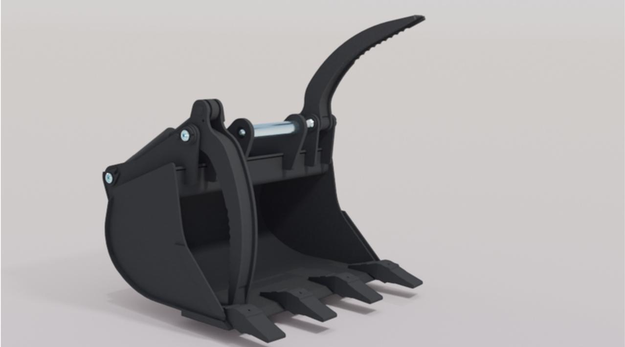
Der Niederhalterlöffel eignet sich für Tiefbauarbeiten kombiniert mit der Möglichkeit Steine oder Holz zu greifen und genau zu positionieren. Der Löffel ist damit optimal geeignet für den Gala-Bau bzw. für Sortierarbeiten im Abbruch- und Recyclingbereich. Die zwei Niederhalter werden getrennt voneinander mit zwei Hydraulikzylindern angesteuert und bieten somit sicheren Halt.
